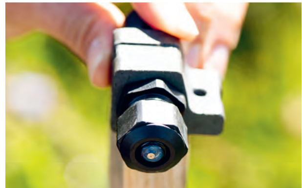
Chiara Paniccia BatSurvey(C) Eurac Research Martina Jaider-3: Das Mikrophon des sogenannten „Batloggers“ nimmt Geräusche im Ultraschallbereich auf, also die Laute der Fledermäuse.
